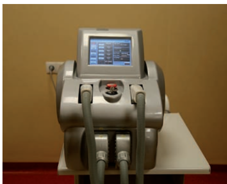
Ryc. 7. Generator IPL z dwoma sondami (SR – do zamykania teleangiektazji, HR – do fotodepilacji).
