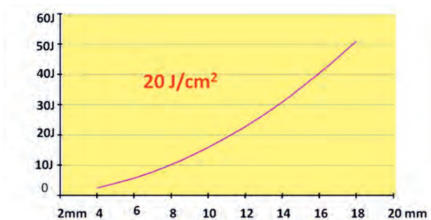
Ryc. 3. Gwałtowny wzrost energii impulsu niezbędny do zachowania stałej gęstości energii przy wzroście średnicy plamki.
